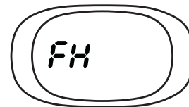
fig. 6 - Cycle de purge de l'air
