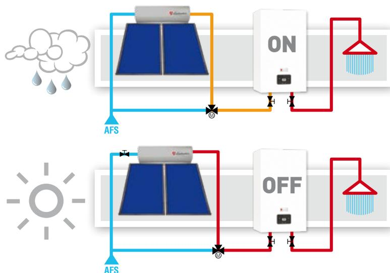
In caso di irraggiamento insufficiente e quindi un pre-riscaldamento modesto dell'acqua sanitaria, la caldaia contribuirà con il calore necessario per raggiungere la temperatura di setpoint richiesta.
